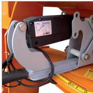
elektr. Schieberöffnung mit 12-V-Verstellmotor
