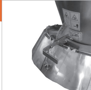
manuelle Streubreiteneinstellung mit Lochsegment
