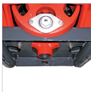
Verstellung der Streubreite ist in 4 Positionen möglich
