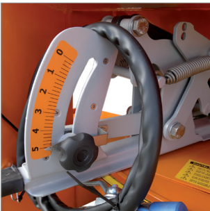
hydr. Schieberöffnung einfachw. mit Absperrhahn
