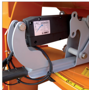
elektr. StreuMENGENeinstellung 12 V Verstellmotor
