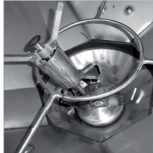
Rüttelringrührwerk INOX, für schlecht rieselfähiges Salz
