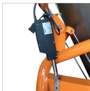
elektr. StreUMENGEinstellung 12 V Verstellmotor
