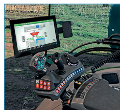
DIGIDEVICE Dosierelektronik, 10 Hz-Wiegetechnik mit 2 Wiegezellen zu je 5.000 kg, ein kompakter Wiegerahmen mit geringem Schwerpunktversatz nach hinten, zwei 12-V-Verstellmotoren und zwei Magnetsensoren sorgen für eine exakte Dosierung und Kontrolle OPTION: ISOBUS Schnittstelle für PRECISION FARMING
