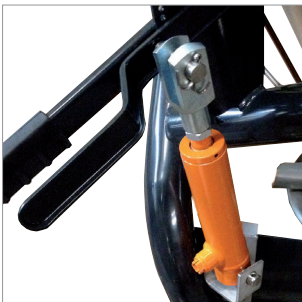
Z101.364 Hydr. Schieberöffnung einfachw. mit Rückstellfeder (nicht möglich für Type C503-2C)
