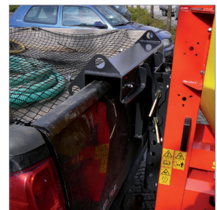
Pick Up-Aufnahme Bordwand, mit Kugelkopfabstützung
